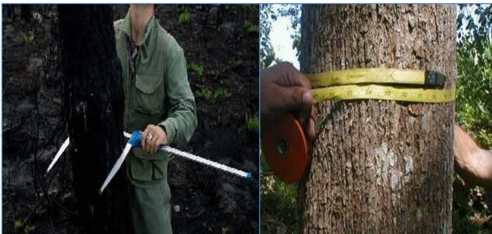
Foto 2. Medición de diámetro con forcípula y cinta diamétrica
